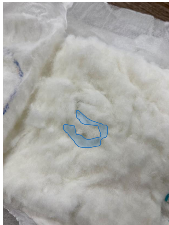
【表面水分吸収体(SAP)の凝固状態確認】
